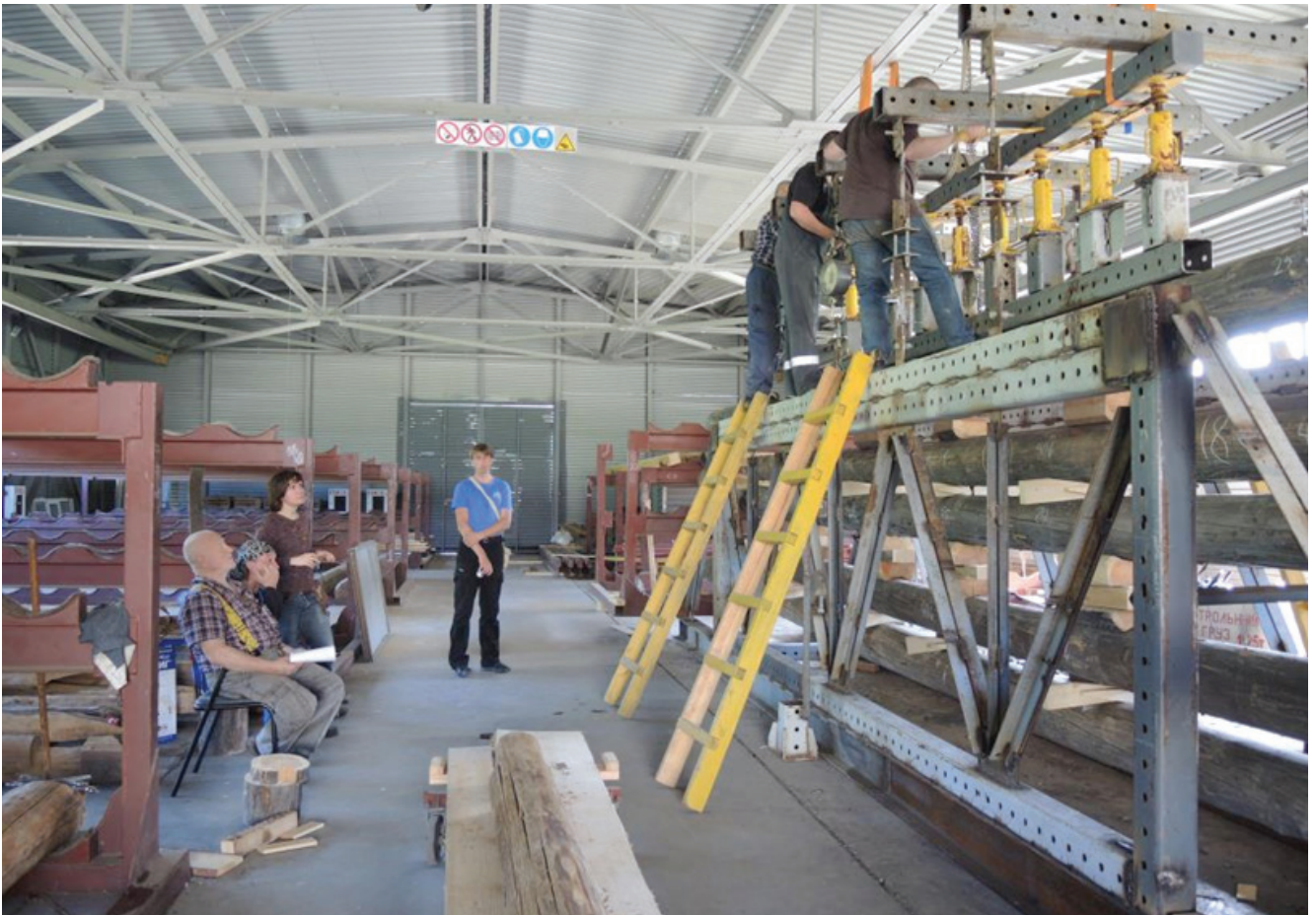
Рис. 16. Нагрузка домкратами испытываемых балок
