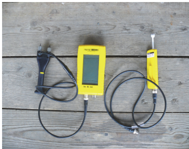
Рис. 9. Переносной прибор измерения влажности древесины
